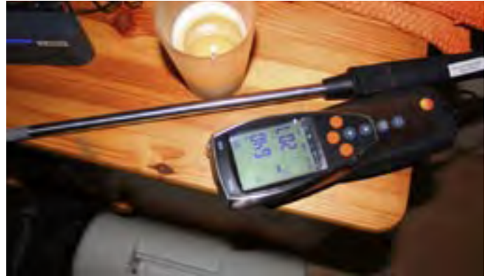
Raumklimamessung: leicht erhöhter Wert bei der relativen Luftfeuchtigkeit. Das Equipment für Bauschadensanalysen ist teuer – rund 50.000 Euro für sichere Diagnosen
